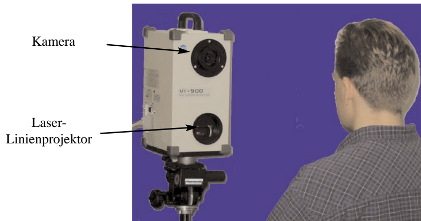
Abb. 1.7: Kommerzielles Aufnahmesystem Vivid 900 der Firma Minolta, das auf dem Prinzip der Linienprojektion beruht.
