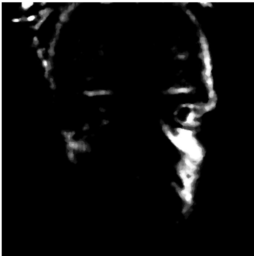
Abb. 6.10: Kontrast-gefilterte Darstellung des Schnittbildes aus Abbildung 6.8. In der Fokusebene ist ein hoher Kontrast erkannt worden. Die übrigen dunklen Bildbereiche entsprechen einem relativ geringen Kontrast.
