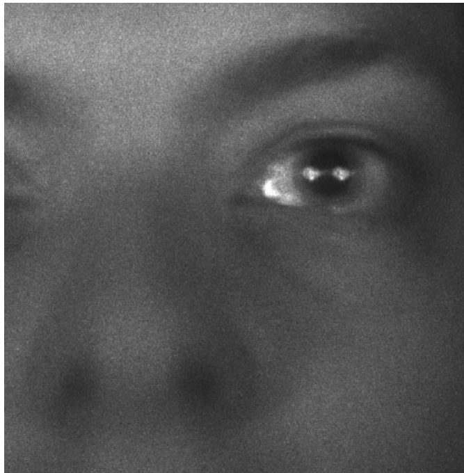
Abb. 6.6a: Aufgezeichnete Schnittbilder des reellen Bildes ohne oszillierende Glasplatte zur Reduktion von Speckleeffekten.
