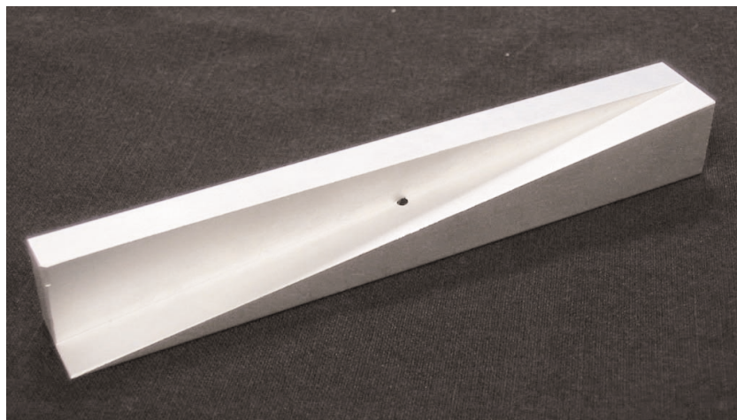
Abb. 6.17: Photo des Probekörpers mit dem die Meßgenauigkeit der Hologramm-Tomographie ermittelt wird.
