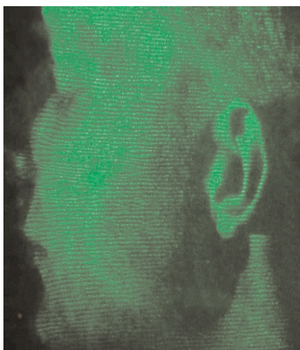
Abb. 4.7: Reelles Bild eines Portrait-Hologramms, bei dessen Aufnahme der Objektstrahl mittels eines Linien-gitters räumlich moduliert wurde.
