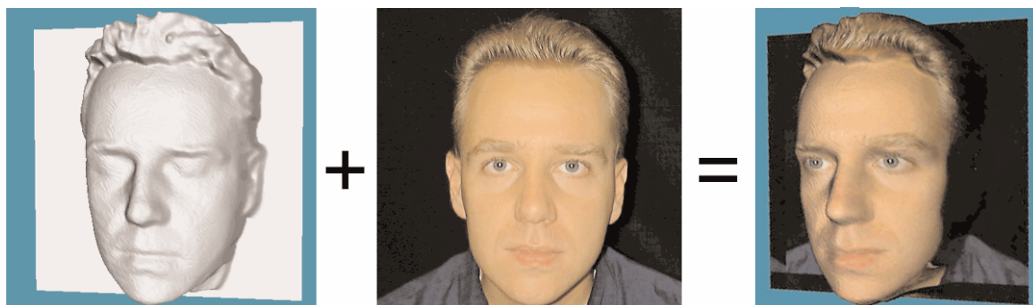
Abb. 7.2: Durch Überlagerung des dreidimensionalen Gesichtsmodells mit einer photorealistischen Textur wird die Wiedererkennbarkeit der Person nochmals deutlich erhöht.
