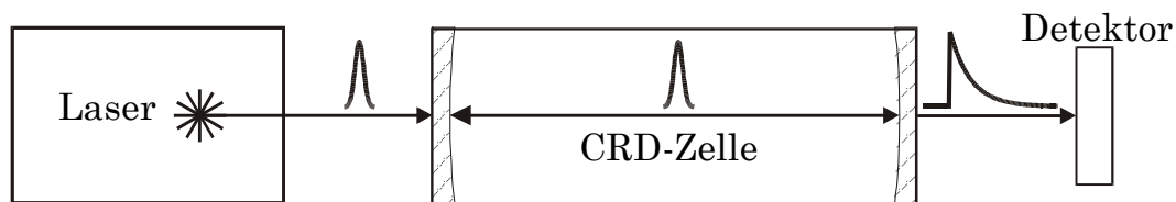
Abbildung 4.25: Die Cavity-Ring-Down-Zelle ist als Resonator aufgebaut. Die Spiegel sind hochreflektierend, der nicht reflektierte Teil des Lichtes wird durch die Spiegel transmittiert. Ein Laserpuls wird von außen durch einen Spiegel in die Zelle geschickt. Das Licht wird in der Zelle hin und her reflektiert und die Lichtintensität klingt ab. Die Abklingzeit wird außerhalb der Zelle hinter einem der Spiegel mit einem schnellen Detektor gemessen. Ein absorbierendes Gas in der Zelle verkürzt die Abklingzeit.
