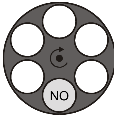
Abbildung 5.8: Filtrerrad mit Gasfilterzelle. Von den 6 Öffnungen des Filtrerrades ist eine mit der NO-gefüllten Gasfilterzelle besetzt.
