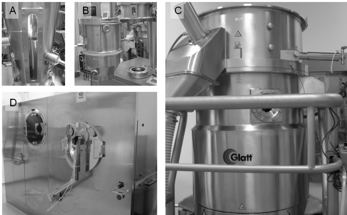
Abbildung 37: Prozessanlagen: Wurster-Einsatz Laboranlage (A), CPS 3 Einsatz Laboranlage (B), CPS 30 Einsatz Pilotanlage (C) und GS Coater Pilotanlage (D)
