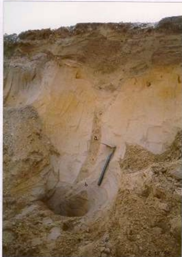
Foto 18: Zugluft in Flugdecksanden über der NT 2 im P 8. (Blickrichtung: Süden. Kluftverlauf: NW10°. a: Zugluft. b: keilförmige Spalte)
