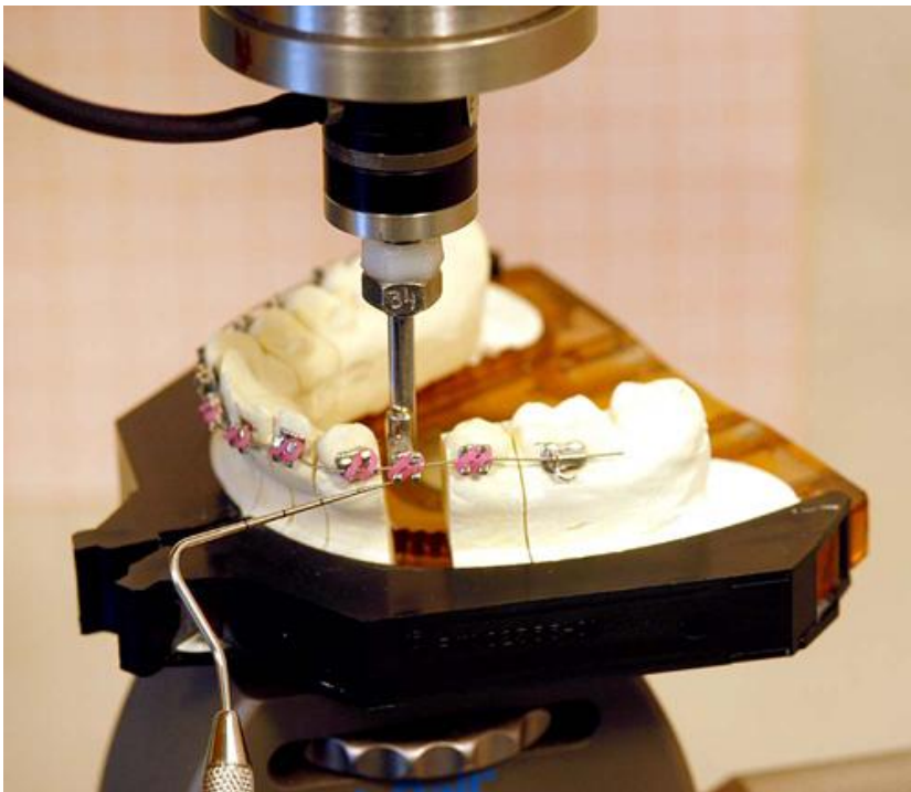
Abb. 10: Positionierung des Sensorbrackets mit Hilfe eines Referenzzeigers
