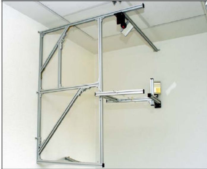
Abbildung 21 :Kephalostat zur Simulation einer digitalen Röntgenaufnahme (nach [54]).
