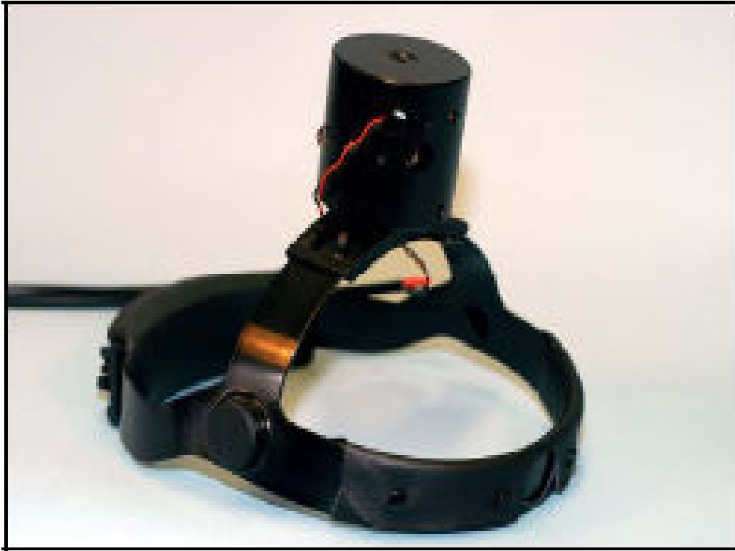
Abbildung 20 : Drei Laserdioden-Module vom Typ LG635-10 der Firma LG Laser Technologies® angeordnet in einem Winkel von 90° in einer Laserkrone (nach [54]).
